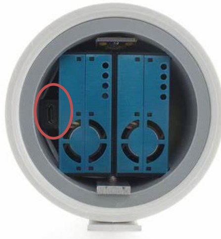
Εικόνα 5. Το κάτω μέρος του αισθητήρα PurpleAir. Η λυχνία που ανάβει όταν ο αισθητήρας βρίσκεται σε λειτουργία επισημαίνεται με κόκκινο κύκλο.
